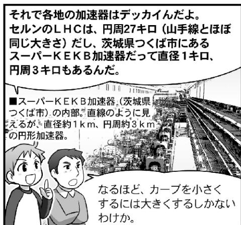
■スーパーKEKB加速器(茨城県つくば市)の内部。直線のように見えるが、直径約1km、円周約3kmの円形加速器。
