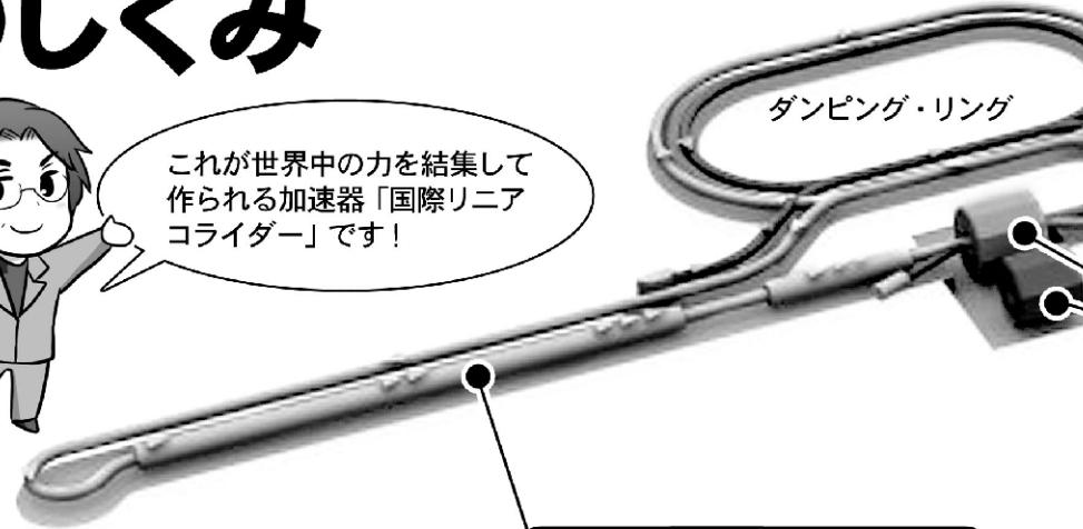
陽電子の超伝導線形加速器
